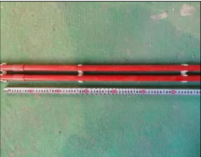
穿线管卡扣固定间隔： 60-80厘米
